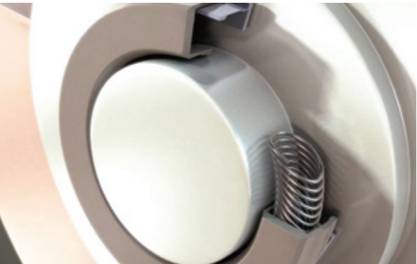
医療診断機器用シール ロッキングリング、PTFEジャケット、斜め巻きコイルスプリングからなるシールは回転によるずれを防ぎ、高いシール性をもたらします。
