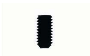
平行光バックライト (MCBP-CB3430) 平行光化により光の回り込みが緩和され、形状が鮮明に判別可能。
