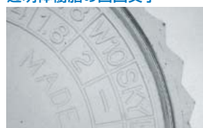
ダイレクトバックライト (MDBL-CB70) 通常の光ではワーク全体を同じ様に光が透過。
