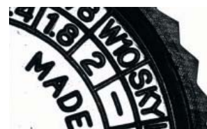
平行光バックライト (MCBP-CB3430) 平行光化により文字部の光が屈折し鮮明に判別可能。また、同様に外形も判別可能。
