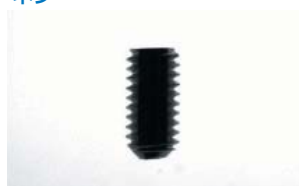
ダイレクトバックライト (MDBL-CB70) 光の回り込みにより、形状が不鮮明
